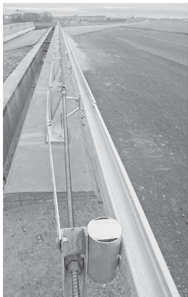
Obr. 8 Celkový pohled na záchytný systém ZMS4/H2 včetně VP tyče na zkušebním polygonu
