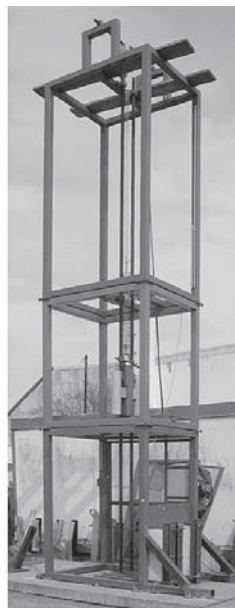
Obr. 5 Laboratorní statická zkouška profilu a výztuh sloupku svodidla
