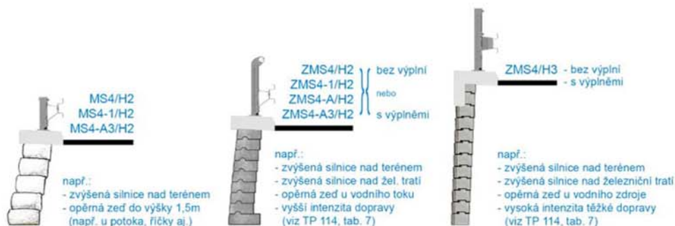
Obr. 2 Příklad výběru svodidla OMO pro liniové stavby
