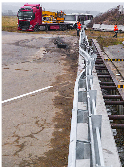
Obr. 5, 6 Deformace svodidel po testovacích nárazech TB11 a TB 51
