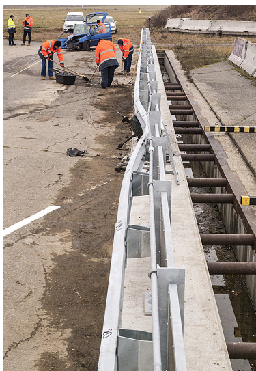
Obr. 5, 6 Deformace svodidel po testovacích nárazech TB11 a TB 51
