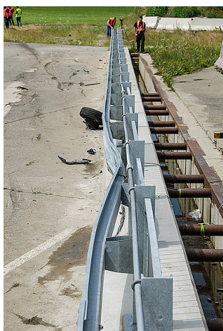
Obr. 5, 6 Deformace svodidel po testovacích nárazech TB11 a TB 51
