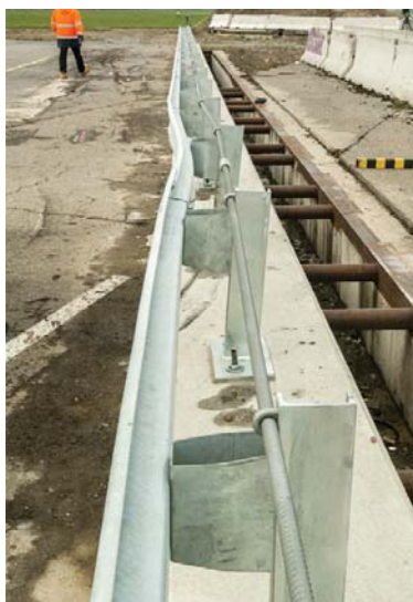
Obr. 5,6 Deformace svodidla po testu TB 11 a TB 51
