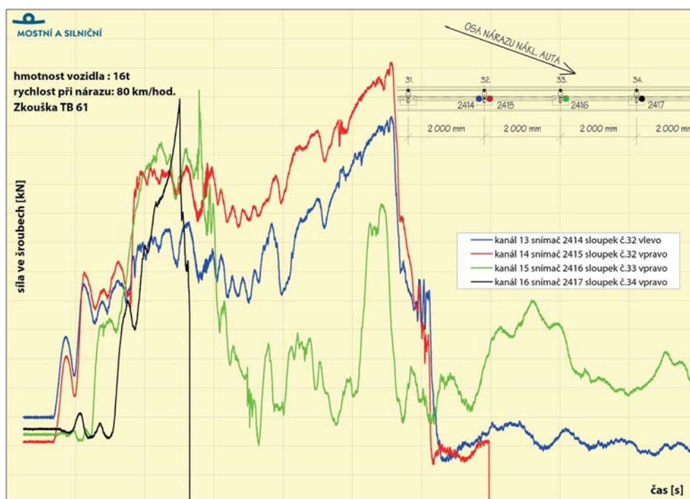
Graf č. 1 Záznam měření sil v kotevních šroubech při testu TB 61
